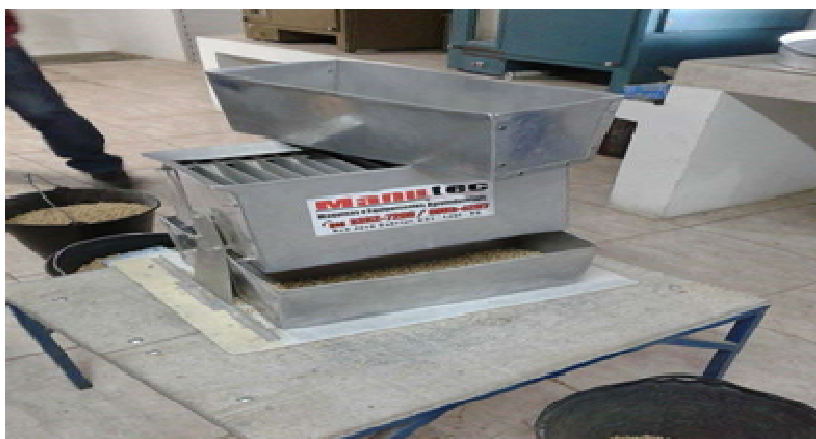
Figura 5 – Quarteador utilizado para homogeneizar amostras e reduzi-las a amostras representativas
