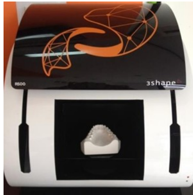
Figura 1- Scanner Digital 3SHAPE – escaneamento do modelo de gesso para obtenção de modelos digitais.
