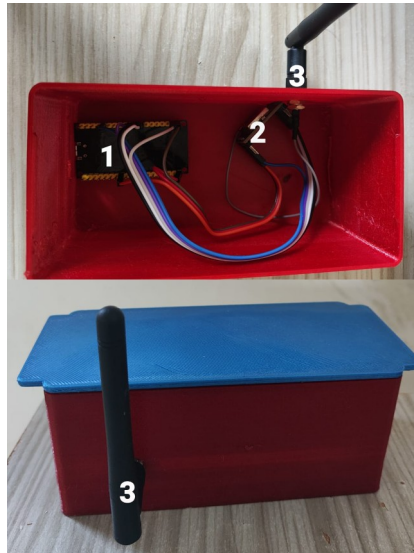
Figura 3 - Receptor: ESP32 (1), LoRa Ra-02 (2) e antena (3).
