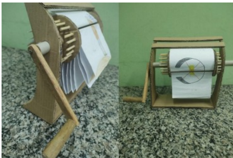
Figura 6. Detalhes do mecanismo de um dos mutoscópios produzidos.
