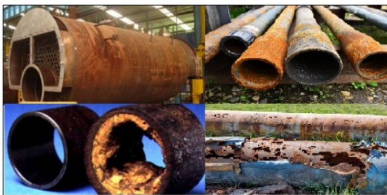
Figura 1 - Estrutura de caldeiras, corrosão e incrustações de tubos. Fonte: https://create.vista.com/pt/unlimited/stock-photos/234137684/stock-photo-fragments-old-large-water-pipes/ (2023).
